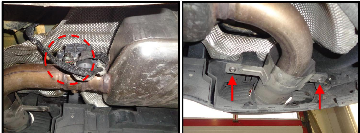
Trennstelle entgraten. Die Aufhängungsgummis am Sportschalldämpfer und Racing Rohr montieren. Burr the cutting edge. Mount the rubber supports on the sport exhaust and racing tube.
